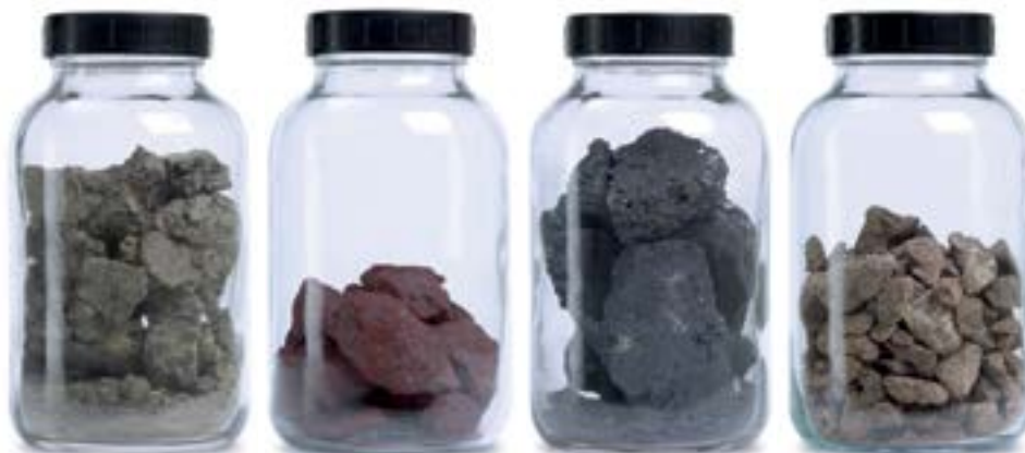
Тестовые материалы для измельчения: цементный клинкер, железная руда, сульфид свинца, алмазная руда
