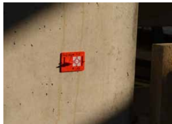
RS30r dans la construction de bâtiments industriels : un point de mesure parfait pour chaque instrument de mesure.
