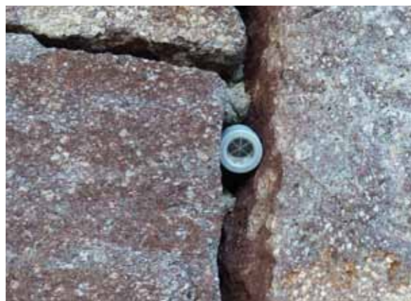
RSMP10, positionnable dans les fentes les plus étroites
