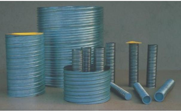
Das **MSL**-Ausparungsrohr ist ein linksgängiges und schraubenförmig gebogen und gefalztes Wickelfalzrohr mit Verstärkungssicken von 2,5 mm bis 9 mm Sickenhöhe. Die Materialstärke der Rohre beträgt je nach Durchmesser 0,20 bis 0,75 mm.
