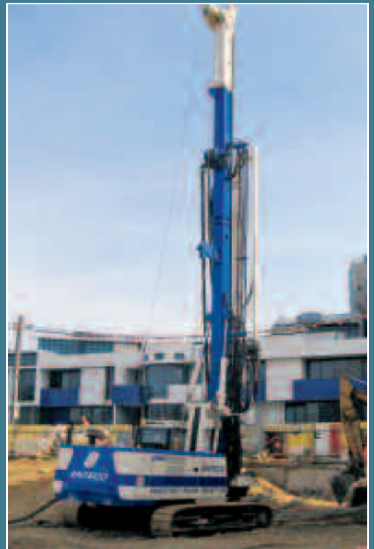
Sidney e Melbourne (Australia). N° 2 E6040M complete di kit pali trivellati, elica continua e kit per diaframmi HGM 20.
