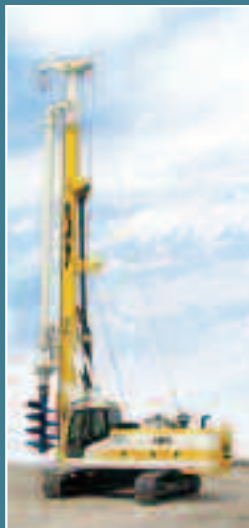
SPAGNA E6040M. con kit pali trivellati ed elica continua.
