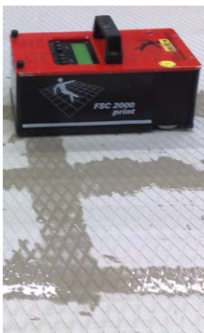
Essai en condition humide de l'empreinte de béton GIAN® 1 losanges avec le FSC 2000 print.
