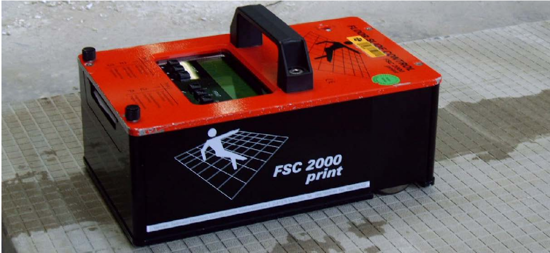
Le FSC 2000 print est un appareil pratique pour mesurer sur place des résistances de frottement.
