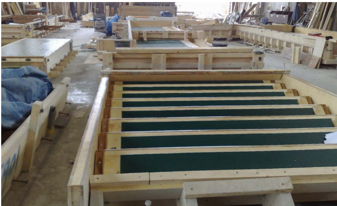
Voorbeelden van houten betonmallen met daarin een GIAN® structuurmat geplakt.
