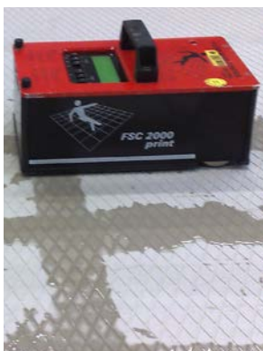
Betonafdruk van de GIAN® 1 groot ruit wordt nat getest met de FSC 2000 print.
