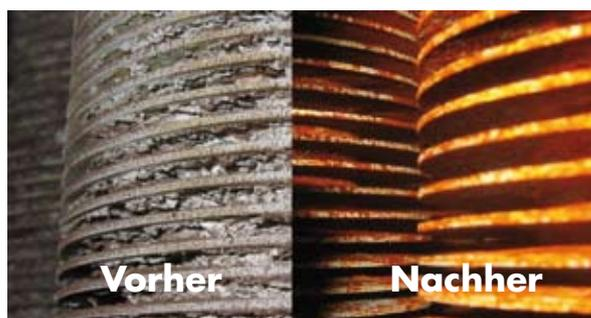
Mit der chemischen Reinigung entfernen wir hartnäckige Anhaftungen an und in Anlagenteilen. Dabei legen wir die Auswahl und Dosierung der Mittel individuell von Fall zu Fall fest. Wir wenden dieses Verfahren überall dort an, wo die Konstellation von Material und Verschmutzung es erforderlich macht oder wir mit diesem Verfah-
