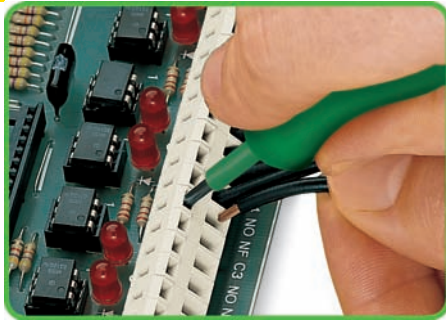
Raccordement des conducteurs « Câblage frontal », série 236
