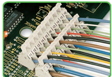
Position des conducteurs lorsque les barrettes à bornes sont postposées et décalées (seulement pour la série 256)
