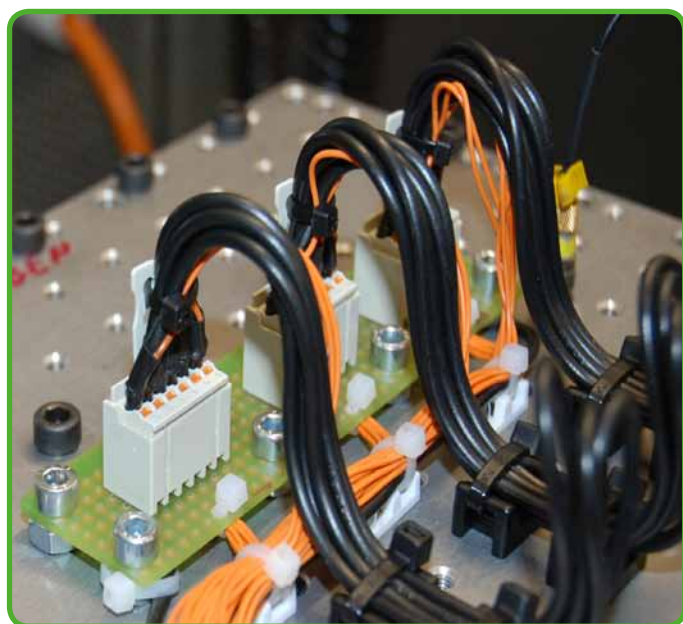
Test de vibration d'une connexion « Fils à carte », série 2091.
