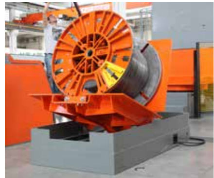
Roller tilter bringing the spooler from the horizontal to the vertical position. Bascualdor de carretes para llevar los carretes de la posición horizontal a la vertical. Basculeur des rochets pour porter les rochets de la position horizontale à la verticale. Vira fieiras para levá-los da posição horizontal àquela vertical.
