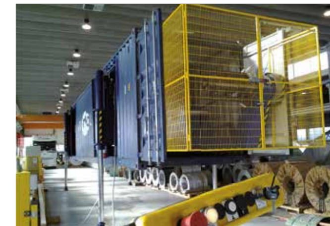
MACCHINA PER PROFILATURA IN CANTIERE
