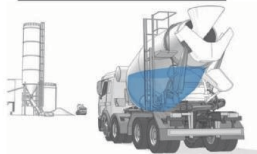
Acheminement de l'eau souillée vers la centrale à béton pour retraitement de l'eau qui sera à nouveau remise en circuit.
