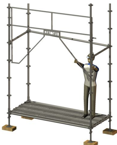
Décrochage du garde-corps du côté du basculeur anti-soulèvement.
