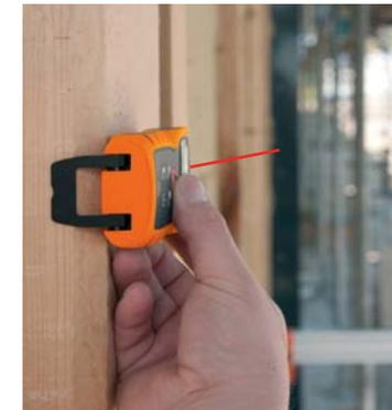
Bien entendu, l'embout multifonctionnel peut être utilisé comme butée mobile pour des mesures à partir d'arêtes extérieures.
