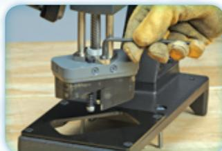
L'ensemble poinçon-matrice est facile à remplacer ou échanger avec les kits poinçon-matrice à acheter séparément.
