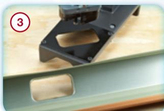
Un puissant mouvement à vis permet de réduire au minimum la force nécessaire en exerçant simplement un mouvement continu de rotation sur la poignée afin de s'assurer que le copeau de métal ne reste pas bloqué dans la pièce de travail au moment de sa réutilisation.
