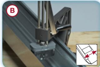
L'ample dégagement de la gorge et les côtés découverts permettent au poinçon d'accéder facilement au-dessus du bord avant ou arrière de la gouttière et d'aligner rapidement des découpes aussi bien dans le sens « A » que dans le sens « B ».
