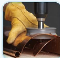
Progression de la découpe de la scie pour sorties de gouttière dans une gouttière semi-circulaire.
