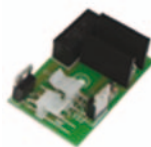
BAT K2 Carte de charge des batteries Bat M016
