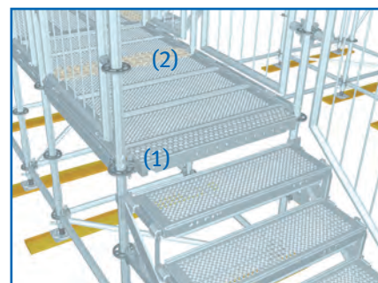
Exemple d'application pour poutrelle-fente (1) et recouvrement de fente (2) (voir pages 18/19)
