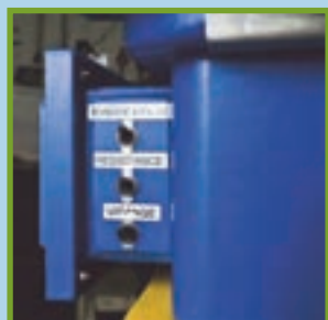
Résistance : permet de mettre la fontaine en chauffe à 37°C. Vidange : permet de vidanger totalement la fontaine.
