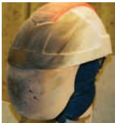
**I'E-MAN 7000** est muni d'un écran recouvert d'or ainsi que d'une cagoule en coton ignifuge pour fournir une protection à 7000A pendant 0,5 secondes.
