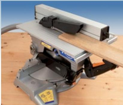
Nueva mesa superior, más amplia, para trabajos auxiliares. El corte es regulable de 0 a 55 mm y dispone de un regle con escala milimetrada para facilitar el corte. Permite adaptar una escuadra (opcional) para cortes guiados en ángulo. (ver accesorios opcionales pág.. 4)
