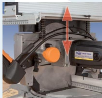
Nuevo sistema de regulación de la altura de la mesa superior mediante cremallera. Proporciona una regulación suave y precisa.
