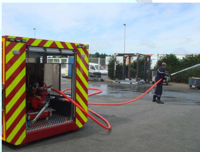
Possibilité de brancher la motopompe soit sur le réservoir intégré à la cellule soit sur borne incendie en cas d'intervention plus importante. Diesel pump is able to pick up water or from fitted in tank or from near side hydrant
