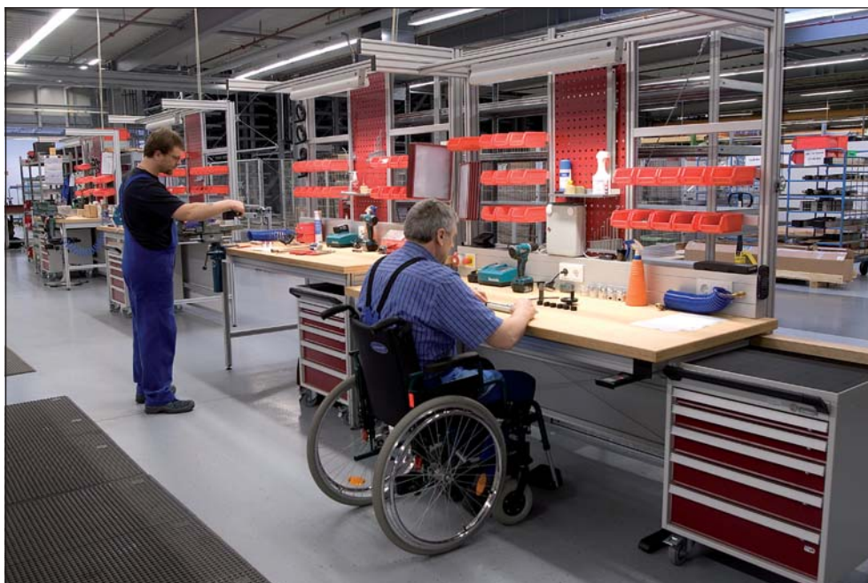
Système à double colonne avec réglage électrique de la hauteur Elektrisch in hoogte verstelbaar tweekolommensysteem
