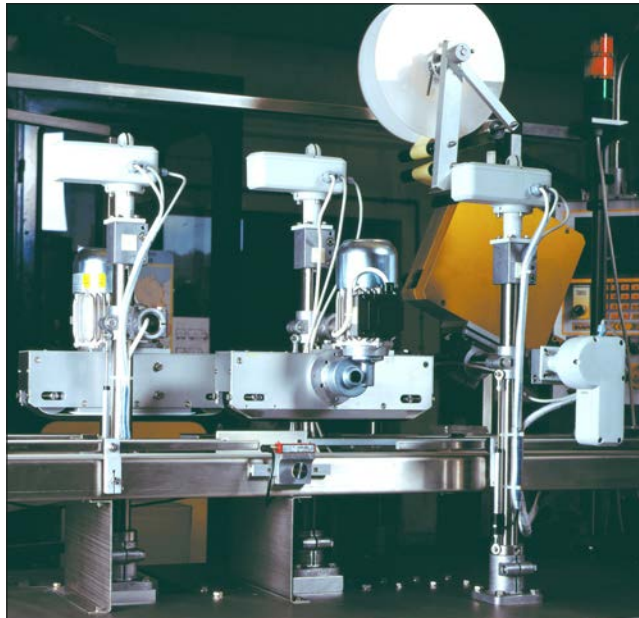
Machine d'étiquetage: le réglage en hauteur est assuré par une unité linéaire de la série E avec volant EHL.
