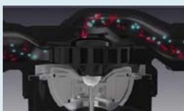
Le flux principal du liquide pompé (bleu) et ses particules de magnétite (rouge) sont maintenus hors de la zone magnétique créée par le rotor.
