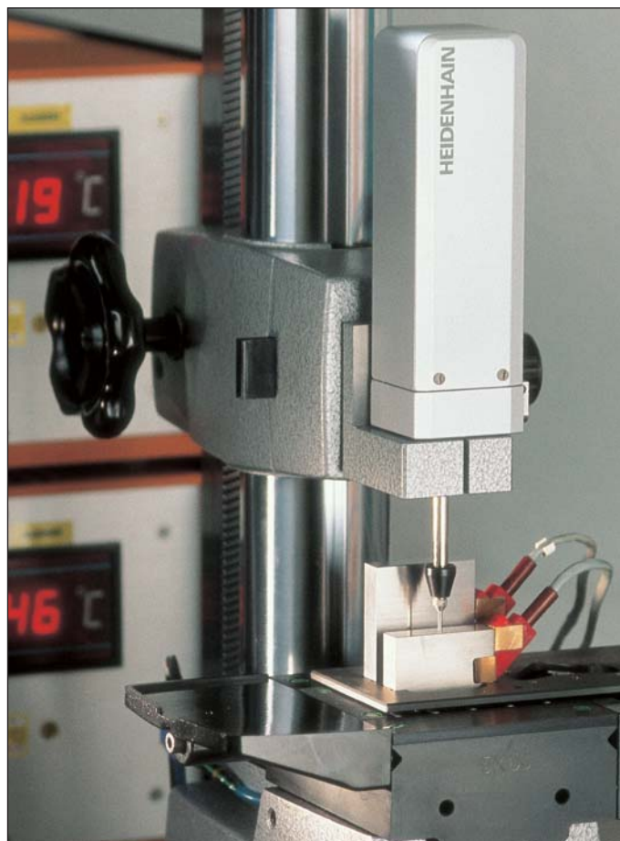
Calibration de cales-étalon
