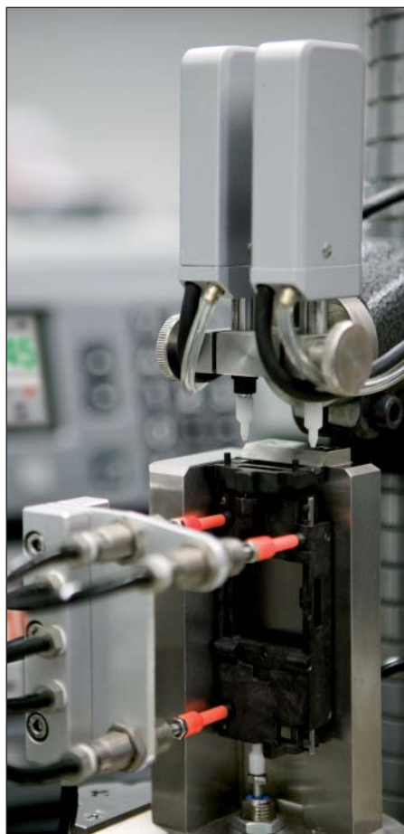
Enregistrement de positions sur table X/Y pour montage de lentilles
