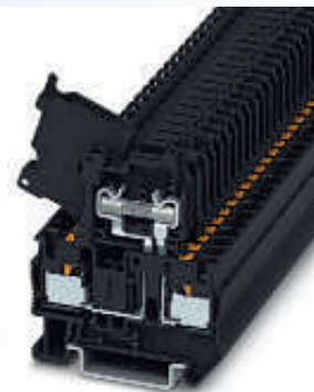
4 (6) mm 2 , 6,3 A, bloc de jonction-fusibles à levier pour fusibles G 5 x 20 mm
