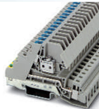
6 (10) mm 2 , 41 A, bloc de jonction à trois niveaux, 1 x phase L, 1 x N sectionnable, 1 x PE
