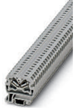
2,5 (4) mm 2 , 30 A, introduction de câble latérale, bloc de jonction de traversée
