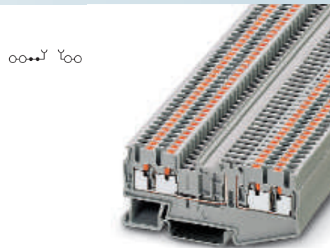
2,5 (4) mm 2 , 20 A, bloc de jonction sectionnement, 4 raccordements
