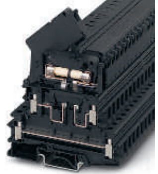
4 (4) mm 2 , 32 A, bloc de jonction à deux niveaux avec bloc de jonction-fusibles à levier pour fusibles G 6,3 x 32 mm
