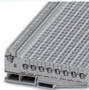
2,5 (4) mm 2 , 24 A, bloc de jonction pour distributeur de potentiel, 8 sorties 1,5 mm 2
