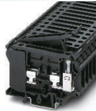
16 (16) mm 2 , 10 A, bloc de jonction-fusibles à levier pour fusibles de type G 6,3 x 32 mm
