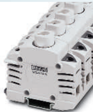
35 (35) mm 2 , 16 A, bloc de jonction-fusibles NEOZED D 01 (E14)
