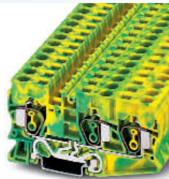
10 (16) mm 2 , 70 A, bloc de jonction pour conducteur de protection, 3 raccordements
