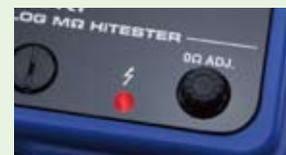
Diese LED leuchtet rot, wenn die Spannung zwischen den LINE- und EARTH-Anschlüssen 20V AC überschreitet, oder wenn nach der autom. Entladung noch mind. 20V DC Restspannung geblieben ist.
