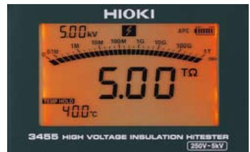
Das Display beinhaltet eine logarithmische, wie auch eine digitale Anzeige und ist mit einer Hintergrundbeleuchtung ausgestattet.
