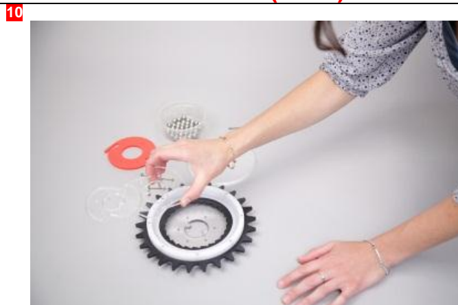
Pose du premier flasque intérieur
