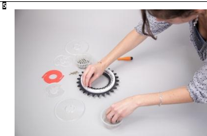
Mise en place des billes dans le second chemin de roulement
