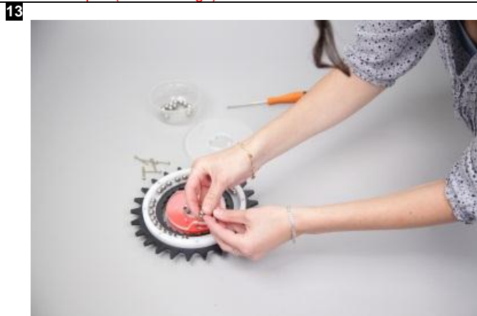
Mise en place des billes dans le premier chemin de roulement
