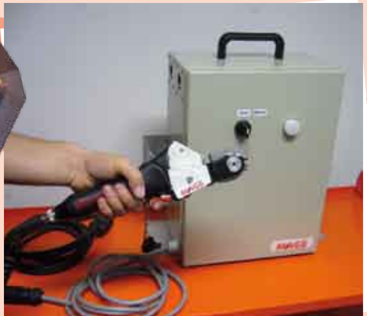
MACHINE D'ATELIER COUPE-CÂBLE ACIER À HAUTE RÉSISTANCE
