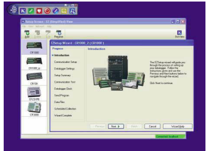
EZsetup vous permet pas à pas de vous aider à choisir le type de centrale de mesure et de paramétrer la communication.
