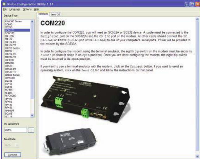
L'utilitaire DevConfig est utilisé pour configurer les centrales d'acquisition, le type de communication des interfaces et les capteurs programmables.
