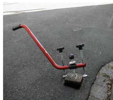
Der Kraftaufwand ist gering, der Zeitgewinn erheblich. Voraussetzung für den Erfolg ist allerdings, dass man den Deckelheber richtig ansetzt und nicht erst im Einsatz damit arbeitet, sondern in Übungen den Einsatzkräften die Hebelwirkung erklärt und zeigt, wie eine Einsatzkraft auch schwere Deckel durch den Einsatz des Öffners als „Bratpfannengriff“ öffnen und schließen kann (z.B. nicht heben, sondern drücken).
