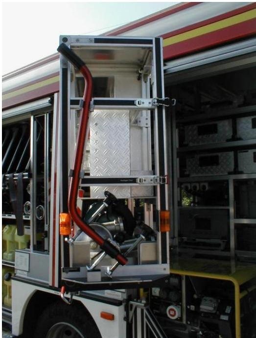
An den anderen Fahrzeugen wird der Öffner gut sichtbar und schnell entnehmbar verlastet.
