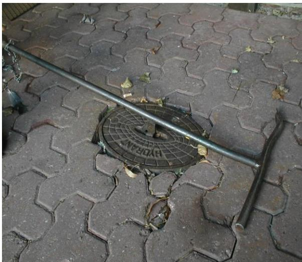
Aufgrund dieser Probleme haben wir uns schon vor etlichen Jahren über eine Lösung dieser Probleme Gedanken gemacht. Wir fertigten einen Haken und befestigten diesen in der Mitte am Unterflurhydrantenschlüssel. Hierdurch hatten wir eine bessere Hebelwirkung und konnten somit mehr Kraft ausüben.
