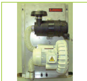
Ventilateurs avec filtration de l'air
