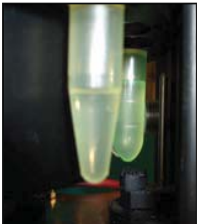
Contrôle de niveau de liquide dans des ampoules
