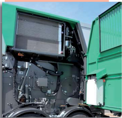
Grobmaschiger Kühler, serienmäßig mit „Cleanfix“ Wendelüfter ausgerüstet
