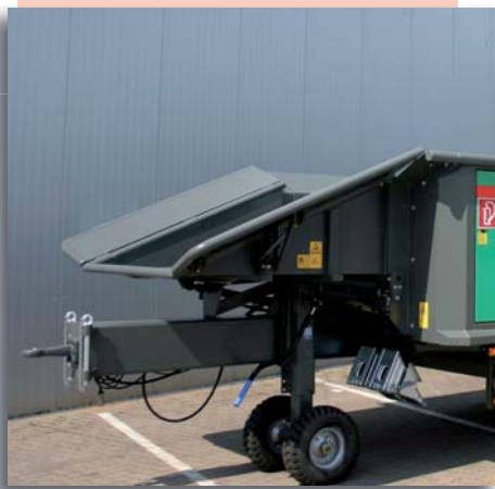
Hydraulischer über Funkfernbedienung verstellbarer Klapptrichter für Aufgabe von Langmaterial (Option)
