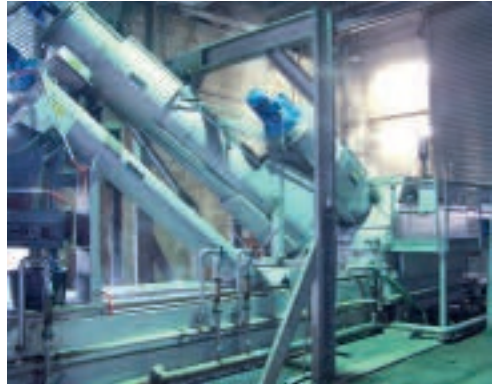
Installation compacte HUBER ROTAMAT® Ro5 BIO sur une installation de biogaz
