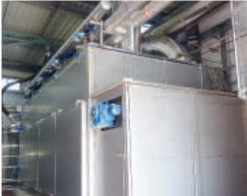
Sécheur à bandes HUBER BT jusqu'à 90% de siccité
