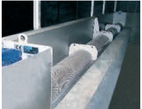
Tamiseur RoK 2 installé devant la surverse
