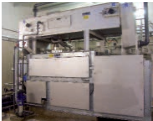
La Presse à Bande HUBER Bogenpress peut être combinée avec la Drainbelt pour accroître sa capacité de traitement
