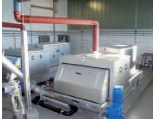
Tamis courbe CurveMax®, grande efficacité de séparation des refus avec un tamis à champs plat et compact
