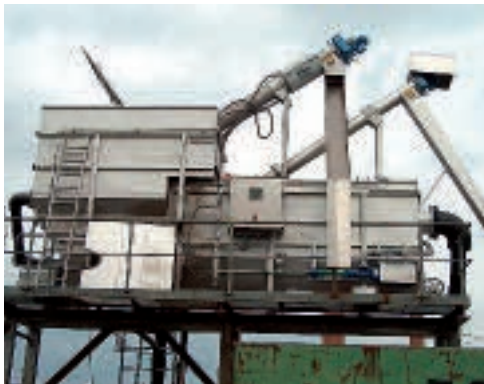
HUBER ROTAMAT® installation compacte Ro5K avec un tamisage à 1 mm
