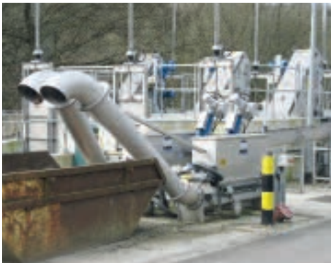
Presse laveuse WAP-L avec secours installé et alimentation par transport liquide
