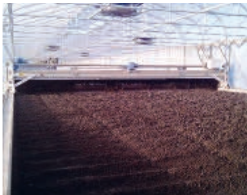
La boue déshydratée devient un granulats sec avec le sécheur solaire SRT
