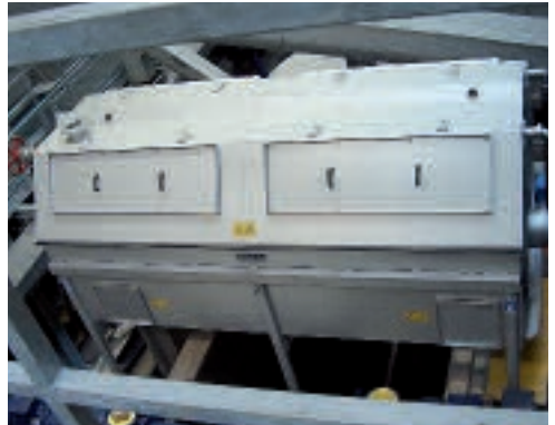
Dégrilleur à tambour rotatif ROTAMAT® RoMesh®, maille de 0,2 à 1,0 mm
