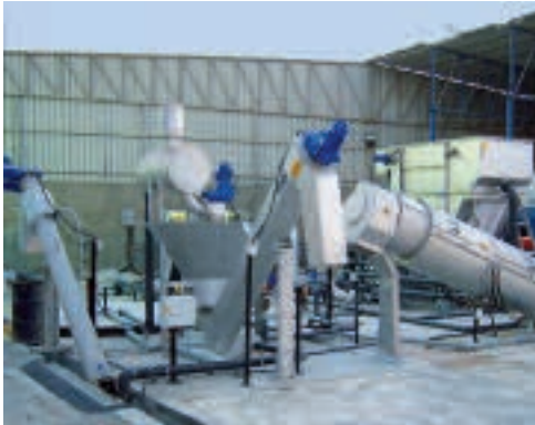
Exemple de traitement des boues combiné avec un traitement des eaux dans une raffinerie
