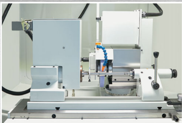
▲ Feststehender Werkstückspindelstock inklusiv fester Spitze und Reitstock mit Spitze.
