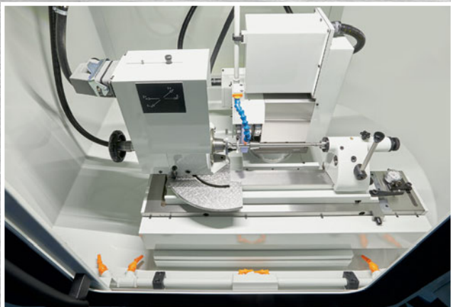
▲ Schwenkbarer Werkstückspindelstock mit integrierter Spannangenaufnahme W 20 und Reitstock mit Spitze.
