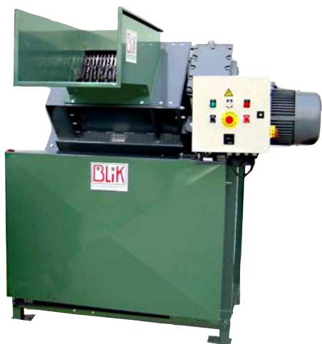
Broyeur BLiK B400-510 sur Container 660 litres
