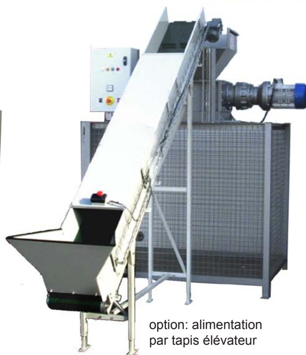
Broyeur BLiK B400 sortie vis sans fin et sac pour destruction d'emballages carton sans mise à plat et production d'une excellente frise de calage
