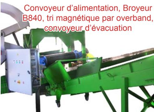
Convoyeur d'alimentation, Broyeur B840, tri magnétique par overband, convoyeur d'évacuation
