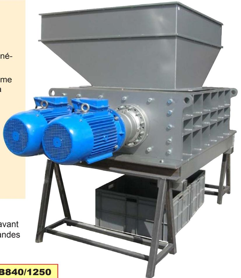
B840-1250 durant son installation, avant l'installation du socle et des commandes
