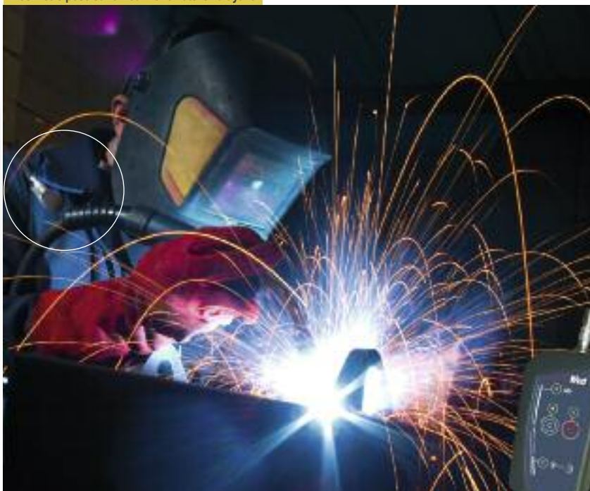
Dosimètre posé sur un ouvrier en atelier bruyant
