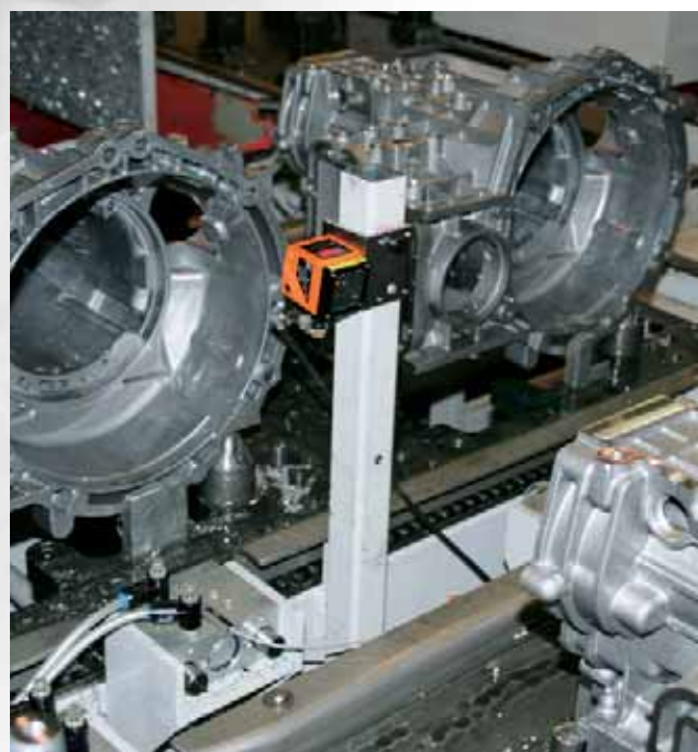
Détection de présence sur système d'entraînement
