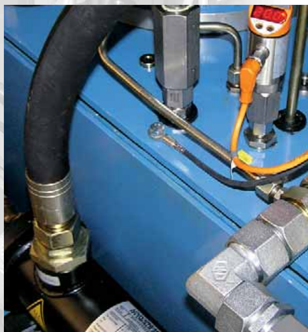
Sonde rigide avec boîtier électronique TR raccordé.
