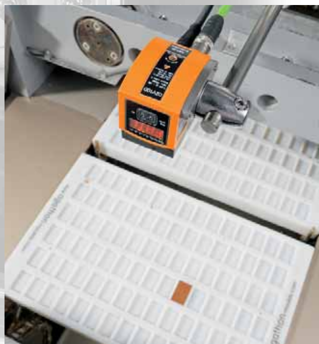
Le capteur d'inspection vérifie si le moule est vraiment vide avant de le remplir de chocolats.
