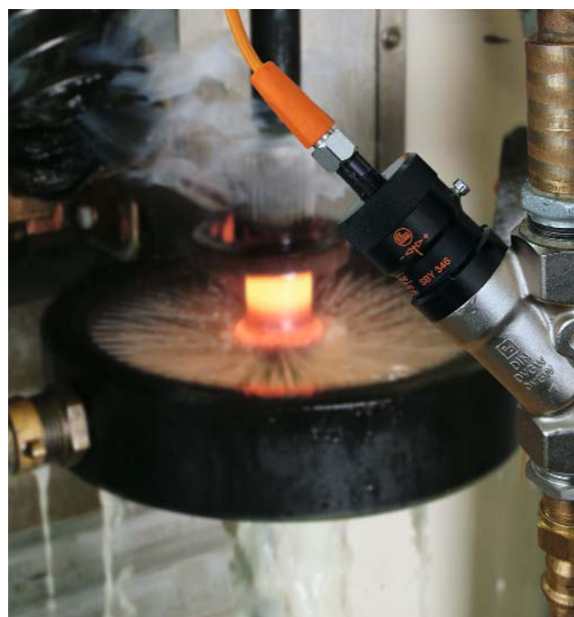
Capteur électromécanique dans le circuit de refroidissement d'un four à induction.
