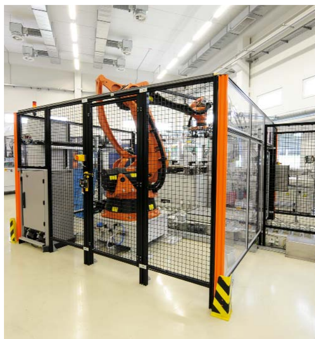
Porte avec interrupteur de sécurité et interverrouillage.
