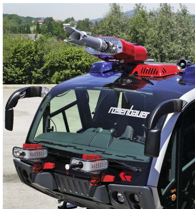
SmartModule utilisé dans une autopompe pour la commande des moteurs de lance à incendie.
