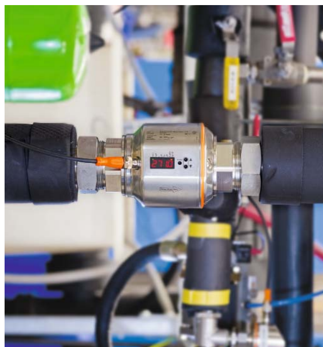
Capteur de débit électromagnétique pour la mesure du volume d'eau dans un système de filtration.
