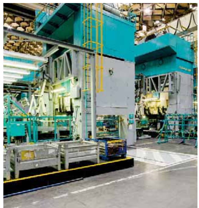
Barrages immatériels de sécurité avec blanking flottant sur une presse.
