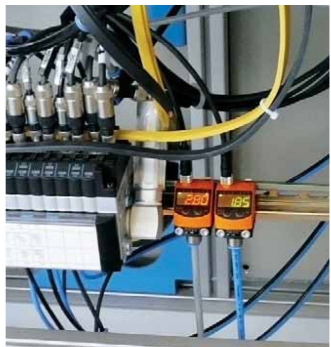
Contrôle de pression dans des systèmes pneumatiques
