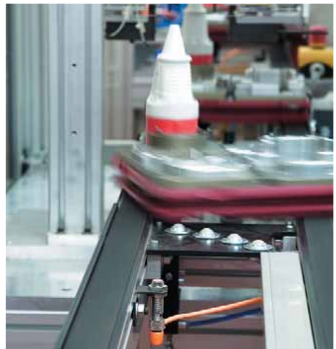
Détection de supports en métal dans un système de convoyage.
