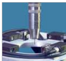
Un OJ laser en barrage peut détecter un objet de 0,8 mm.
