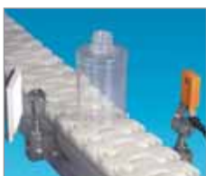
Un système de réglage spécifique permet le paramétrage de la cellule sans avoir besoin de l'objet transparent.
