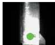
Point de soudure présent
